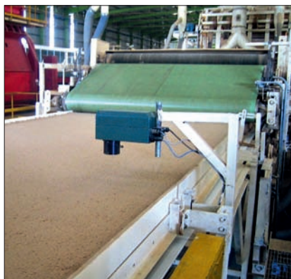
Устройство измерения влажности, установленное над волокнистым ковром
