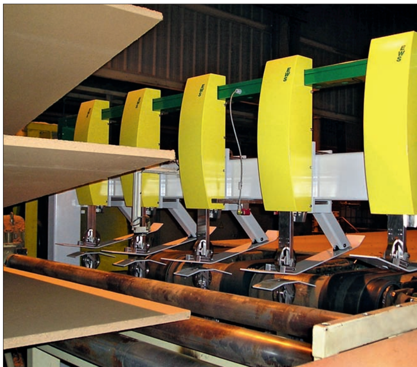
Устройство измерения толщины, установленное на выходе пресса
