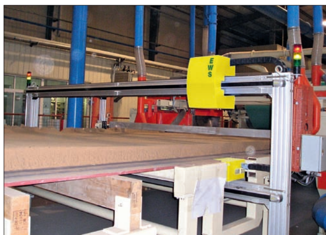
Устройство измерения веса на единицу площади, установленное на входе в пресс
