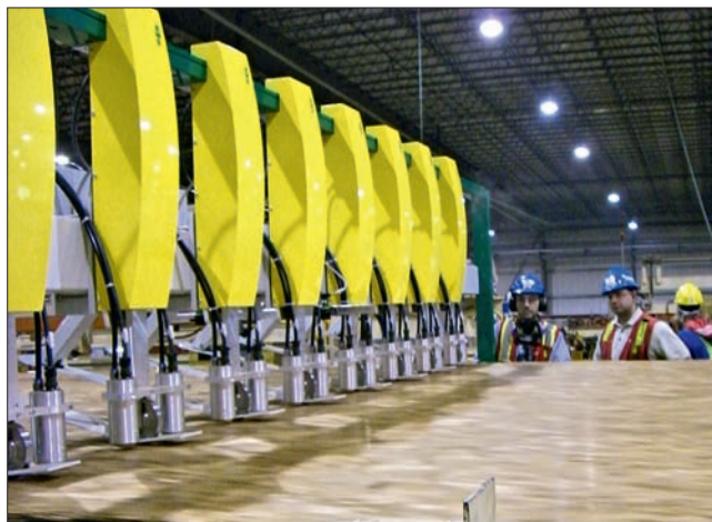
Устройство для распознавания внутренних дефектов, установленное на выходе пресса
