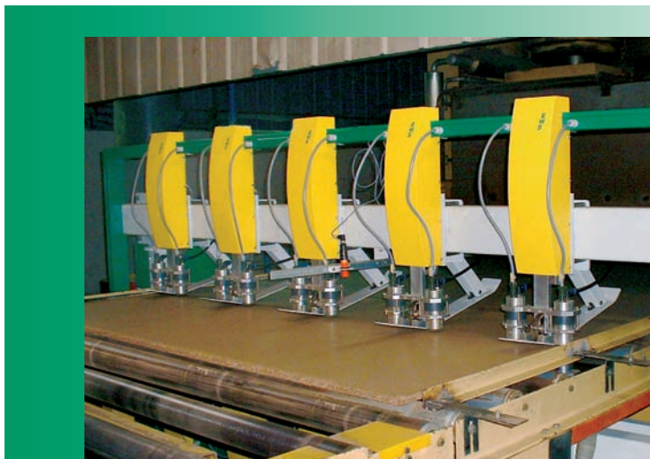
Комбинированная измерительная система по обнаружению внутренних дефектов и измерению толщины плит ДСП
