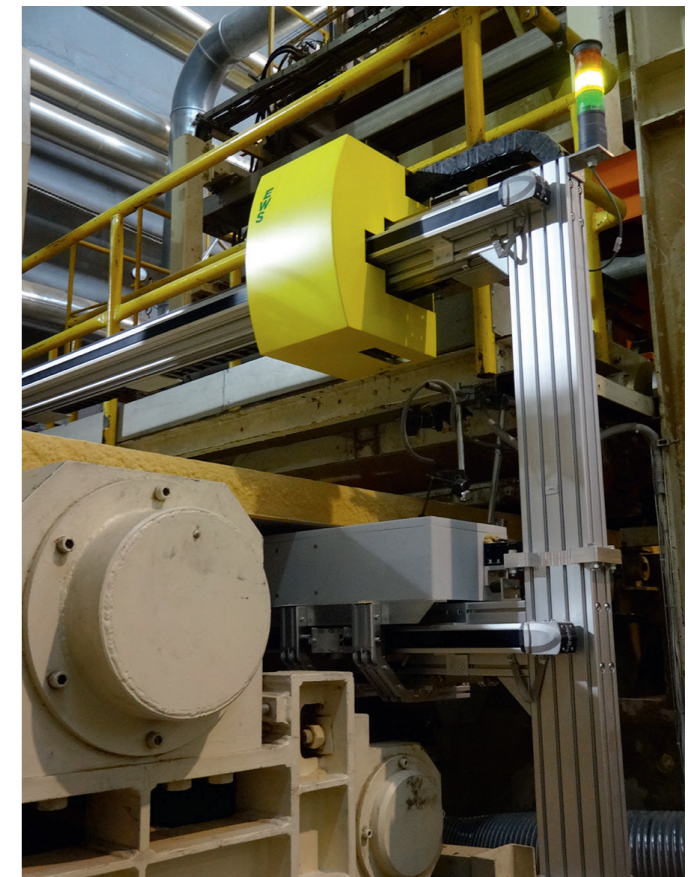
Рис. 3. Прибор для измерения поверхностной плотности в поперечном направлении MASS-SCAN X ME, изготовленный по технологии MultiEnergy
