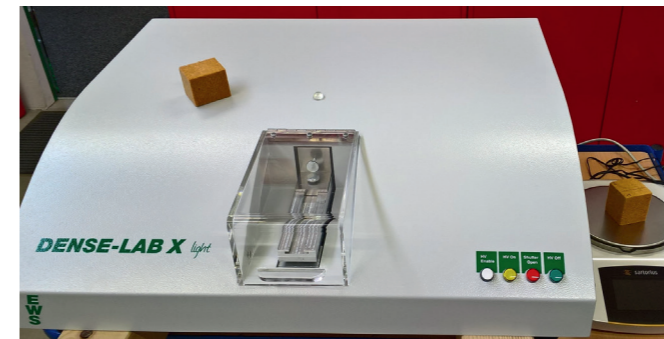
Рис. 2. Лабораторный анализатор профиля плотности DENSE LAB X light, выполненный по оптимизированной рентгеновской технологии для изоляционного материала
